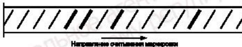
Рисунок 2 — Пример прокатной маркировки предприятия-изготовителя под номером 14
