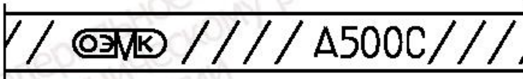
Рисунок 1 — Пример прокатной маркировки арматурного проката класса А500С производства ОАО «Оскольский электрометаллургический комбинат»
