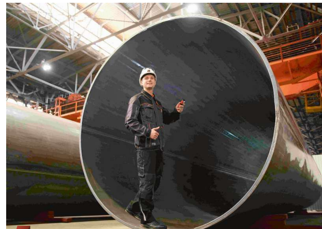
ТМК освоила производство труб диаметром 2 520 мм на ЧТПЗ
